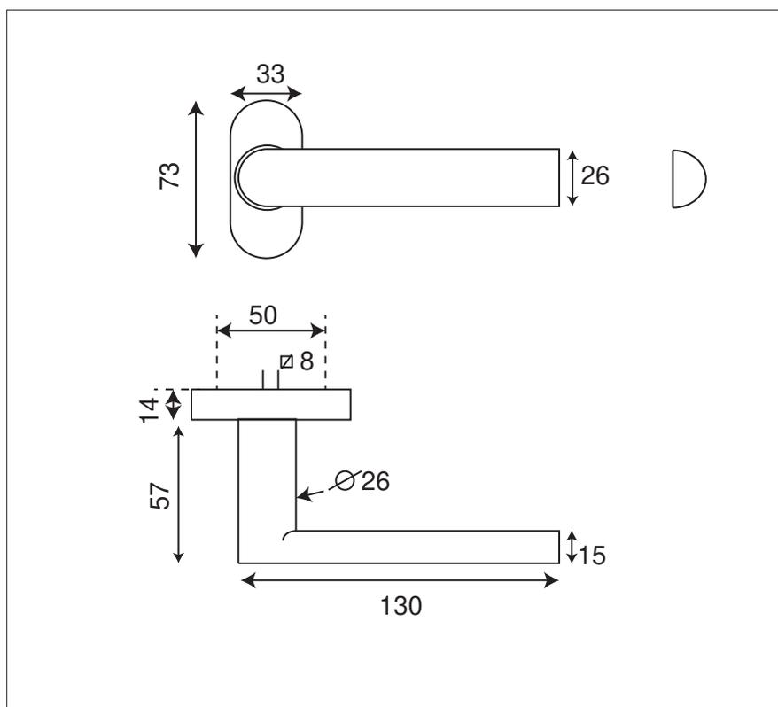
*Ce modèle robuste a une sous-construction en fonte et nylon spécialement adaptée aux menuiseries en alu.
