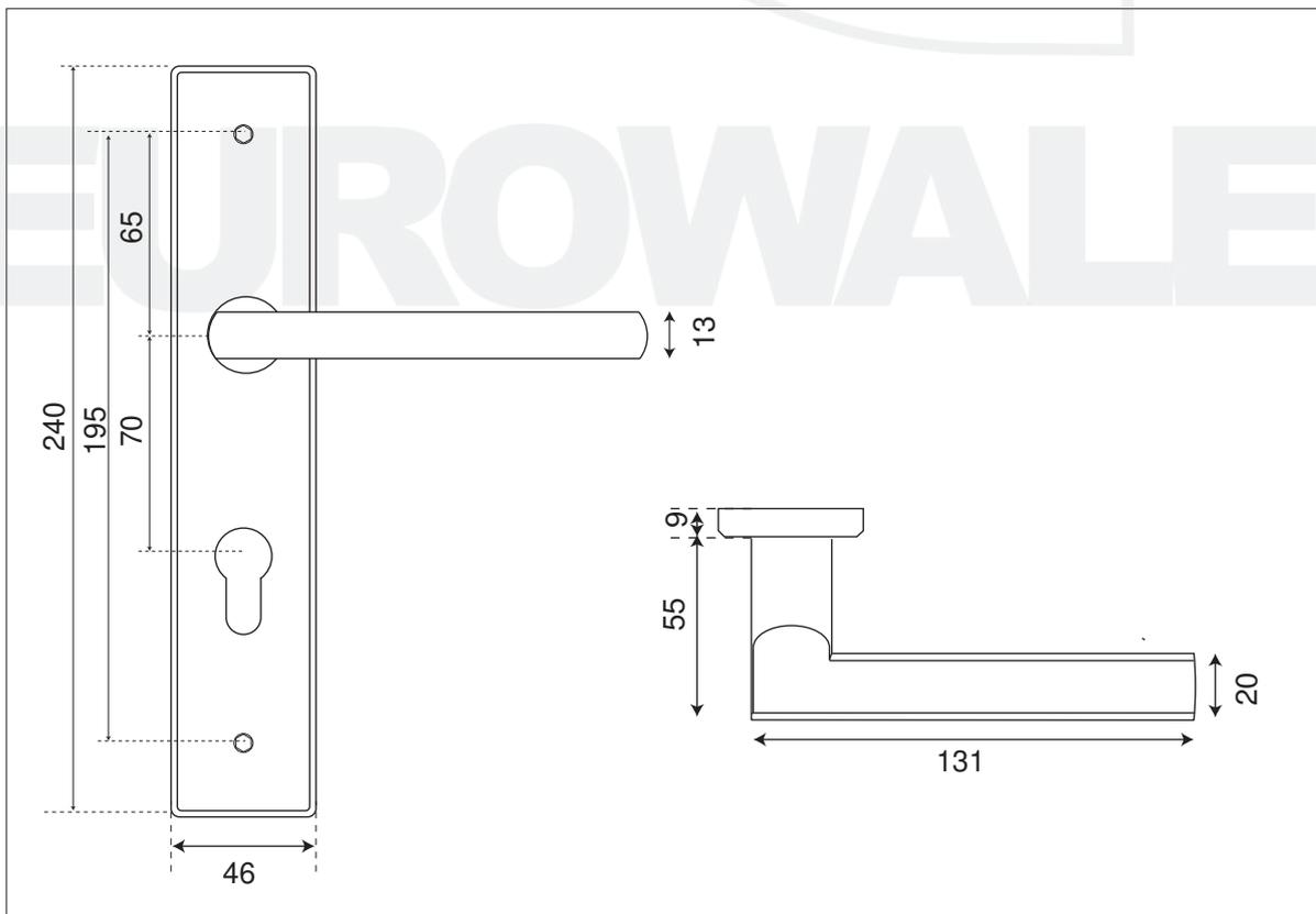
Poignée à section rectangulaire sans ressort de rappel, sur plaque biseautée en fonte massive de 2mm d'épaisseur qui assure la solidité du modèle, renforcée par les vis de 5mm tête 6 pans non visibles pour garantir la sécurité extérieure carré de 7mm, pour portes de 40 à 65mm (à spécifier)
