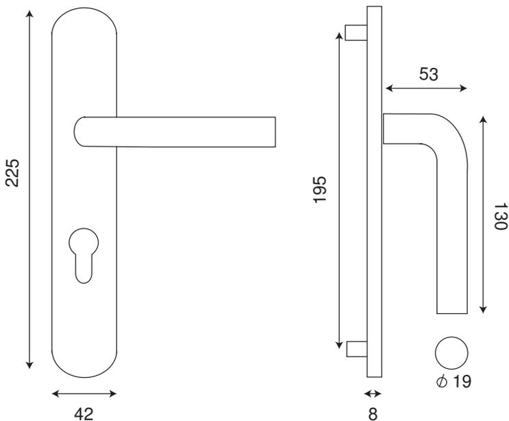
Assemblage par vis sur piliers taraudés
