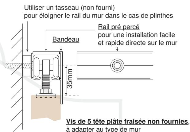
4/ Monter les platines de fixation en métal sur le chant supérieur de la porte à 100mm du bord minimum
