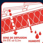
**EN ÉTÉ**, la vapeur d'eau provient généralement de l'extérieur vers l'intérieur et l'humidité relative de l'air est élevée aussi bien à l'intérieur qu'à l'extérieur. Le film de copolymère de polyéthylène s'ouvre alors et la vapeur d'eau peut s'écouler de l'extérieur vers l'intérieur car le film devient perméable à la vapeur d'eau.
