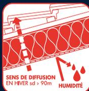
**EN HIVER**, quand il fait plus chaud à l'intérieur qu'à l'extérieur, la vapeur peut s'écouler de l'intérieur vers l'extérieur. L'humidité relative est généralement assez faible en hiver. Le film de copolymère de polyéthylène devient plus fermé, agissant alors comme un pare-vapeur. Ce phénomène assure une transmission quasi inexistante de vapeur d'eau dans la structure isolante pendant la saison froide, et évite ainsi le risque de condensation.
